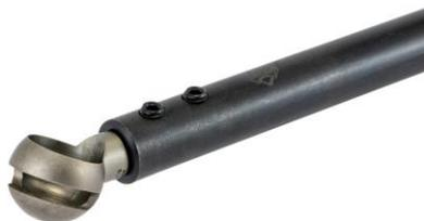
Für Langholzarbeiten (Kelche, Becher, Dosen ...), die besondere Geometrie der Schneide bzw. Kugelform des Werkzeuges ermöglicht ein sicheres Arbeiten und eine glatte Oberfläche. Der Kugelschneider arbeitet schneidend, dank der Öffnung werden die Späne beim Arbeiten abgeleitet; nachschärfbar.
